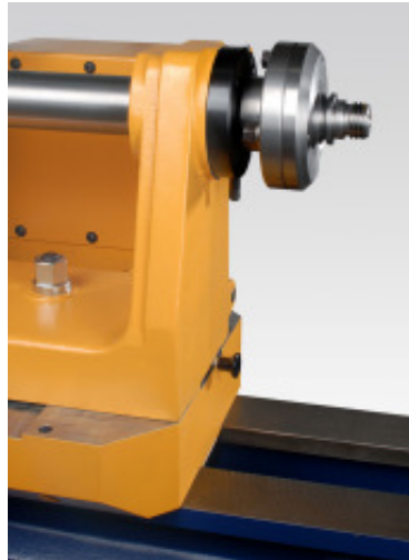
mit Spindelgewindeflansch M33 DIN800 mit MK2 Innenaufnahme
